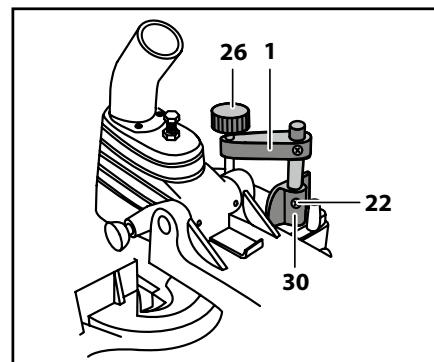
Для надежной фиксации заготовки при пилении на фронтальном упоре 15 предусмотрены гнезда 30 для крепления струбцины. Вставьте (кроме ЗПТ-190-1200 пл) стержень струбцины в гнездо и затяните винт 22 на задней стороне гнезда для закрепления стержня. Отрегулируйте струбцину в соответствии с размером и формой заготовки. Струбцина может быть установлена в упоре как слева, так и справа от пильного диска.
