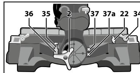
Ослабьте рукоятку 2 фиксации наклона пилы, приведите голову в вертикальное положение, отпустите стопорную гайку болта 35 и, используя угольник, установите пильный диск под углом 90° относительно поворотного стола 10 регулировкой упорного болта 35. Затяните стопорную гайку.
